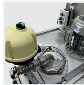
Schmutzwassertank mit integriertem Zulaufgrobfilter (<5 mm) sowie Rührvorrichtung
