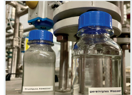
Vergleich Druckguss Abwasser zu gereinigtem Wasser
